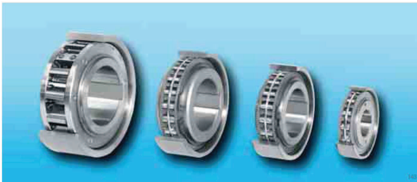
Rodzaj z odchyleniem elementów blokujących typu X podwyższona żywotność przez odchylenie elementów blokujących przy szybkoobrotowym pierścieniu wewnętrznym
